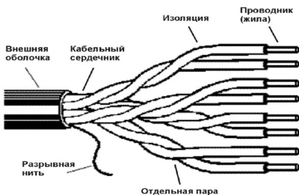
Рис. 2 - Устройство кабеля "витая пара"
